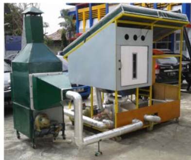
Slika 30. Solarna sušara sa toplotnom pompom, i integrisanim prijemnikom i ložištem na biomasu
