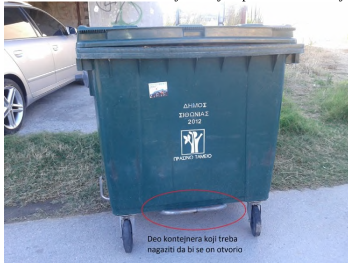
Slika 9. Kontejner sa nožnim mehanizmom za otvaranje
