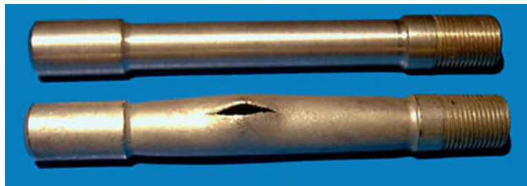
Slika 9: Izgled epruveta od CuZn37 pre i nakon rasprskavanja
