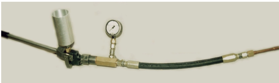
Slika 8: Injektor ulja sa montiranom epruvetom za ispitivanje
