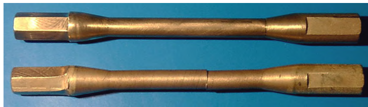
Slika 5: Izgled epruvete pre i nakon uvijanja
