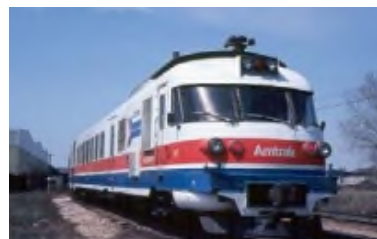
Slika 27. Prikaz mesta ugradnje i izgled turbopunjača Slika 28. Prikaz lokomotiva sa pogonom na gasnu turbinu
